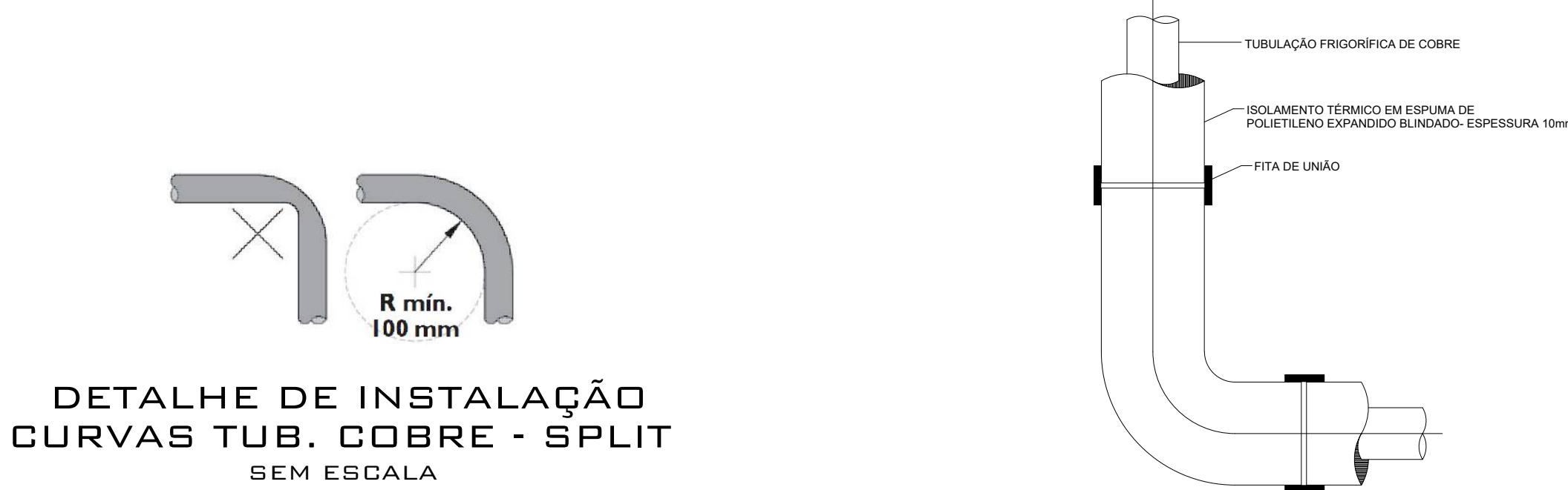
DETALHE DE ISOLAMENTO TUBULAÇÃO MECÂNICA SPLIT SEM ESCALA
